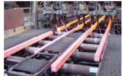
9 et 10. Optimisation de découpe de billettes par pesage
