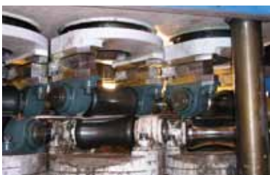
15. Mesure de forces sur rouleau redresseurs
